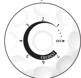
Control electromecánico Figura 1
